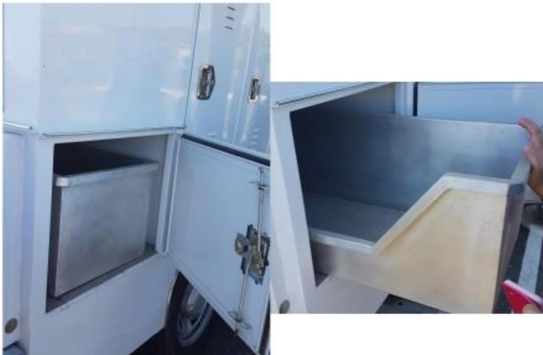
▲最後方下層，可放置大體，後車箱皆可水洗，另有集水管線排出
