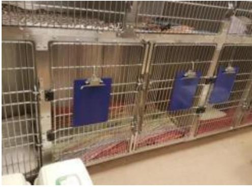
▲手術房外單獨照護籠，不銹鋼籠具，中間隔板抽取後可併籠，彈性調整空間，籠外夾板可夾資動物資料卡
