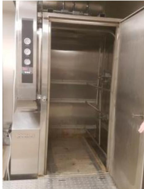
▲此為蒐集各區犬貓用碗台車，蒐集完畢各區犬貓用碗台車直接推入右圖洗碗機器內，5 分鐘後完成清洗及消毒
